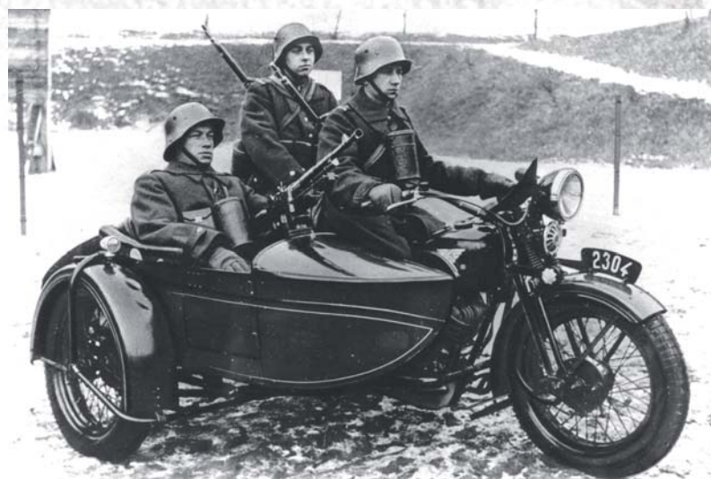
Motocykliści pancerno-motorowej 10. Brygady Kawalerii z erkaemem wz.28 zamontowanym na motocyklu CWS M111 Sokół 1000 FOT. NARODOWE ARCHIWUM CYFROWE (WWW.NAC.GOV.PL)
