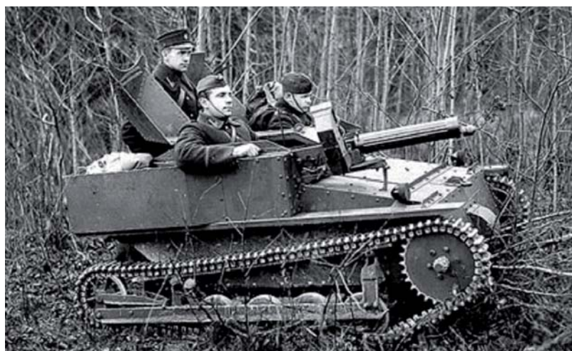
Brytyjska tankietka Carden-Loyd Mark VI uzbrojona w kaem Vickers – od tego się zaczęło FOT. ARCHIWUM
