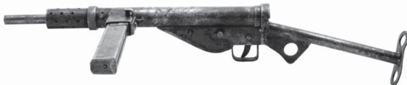
— Pistolet maszynowy typu Sten produkcji konspiracyjnej. Wzorowany na konstrukcji brytyjskiego pm Sten Mk. II kal. 9 mm, mający jednak liczne uproszczenia w stosunku do oryginału. Zrezygnowano z przyrządów celowniczych, obrotowe gniazdo magazynka zastąpiono stałym, przyspawanym do komory zamkowej, inne jest też mocowanie osłony lufy FOT. ZE ZBIORÓW MUZEUM POWSTANIA WARSZAWSKIEGO
