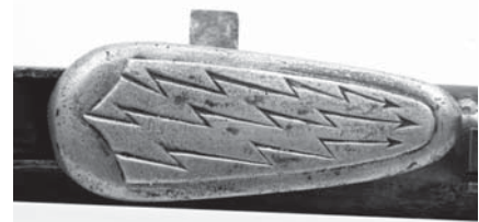
■ Stopka od „Błyskawicy”, trzy przemysłnie wkomponowane strzałki (z czterema załamaniem) wycięte na stopce kolby miały zwiększyć chropowatość i przyczepność stopki do ramienia. FOT. ZE ZBIORÓW MUZEUM POWSTANIA WARSZAWSKIEGO
