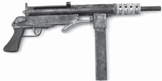
— Konspiracyjny pistolet maszynowy „Błyskawica” kal. 9 mm skonstruowany przez inż. Wacława Zawrotnego i inż. Seweryna Wielaniera na bazie brytyjskiego pm Sten i niemieckiego pm MP-40. Półfabrykaty wytwarzane w różnych warsztatach montowano w zakładzie wyrobu siatek znajdującym się na tyłach kościoła przy pl. Grzybowskiem 3/5 w Warszawie
